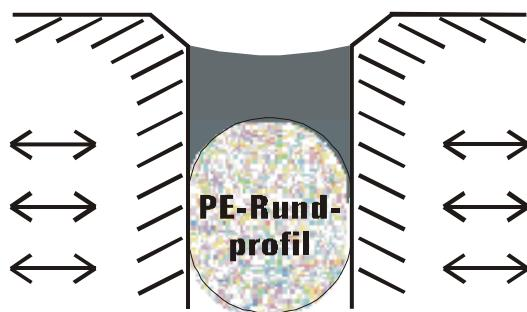
Schéma d'un joint correctement dimensionné avec un cordon rond en PE comme matériau de remplissage
