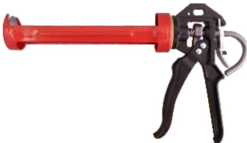
Drehbare Kartuschenpresse für Normkartuschen. Automatische Kolben-Entlastung zu- oder abschaltbar. Kraftübersetzung: 18:1. Gewicht: ca. 0.83 kg.
