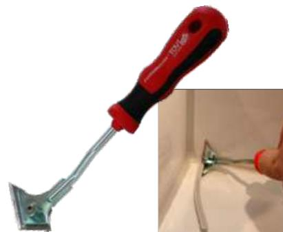
Speziell entwickeltes Zweiklingenwerkzeug zum Herausschneiden von Fugen an 90° Kanten (so genannten Dreiecksfugen). Entfernt rasch und sauber Anschlussfugen aus Silikon und anderen Dichtstoff-Materialien. Nur für glatte und harte Untergründe wie Plättli, Keramik, Marmor oder Granit.
