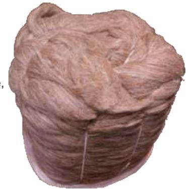
Handling (kein Drahtgeflecht) ermöglicht eine deutlich raschere Montage als bei konventionellem „Seidenzopf“ aus Recyclingmaterial. In seiner verdichteten Form hat dieses Naturprodukt eine besonders hohe Schall- und Wärmeisolierung. Schafwolle ist dampfdiffusionsoffen und besitzt natürliche Thermoregulationseigenschaften, d.h. sie kann bis zu 33% ihres Trockengewichts an Feuchtigkeit aufnehmen ohne sich nass anzufühlen.
