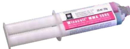
Transluzenter, struktureller Universalklebstoff, 2 min verarbeitbar. Speziell entwickelt für diskrete, klare Verbindungen. Geeignet für Metall, Glas (nur im Innenbereich), Acryl, Holz, Keramik und viele Kunststoffe (ausgenommen PE & PP), Steinzeug und vielem mehr. Auch zur Reparatur und Ausbesserung. Das ausgehärtete Produkt kann mechanisch bearbeitet und überlackiert werden.
