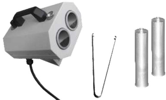
Für zwei 310 ml Alu-Kartuschen. Regelbar von 40°C bis 140°C. 500 W Heizleistung sorgen für rasche Erwärmung der Kartuschen (hohe Produktivität). Der stabile, tragbare Kartuschenofen wiegt ca. 5 kg und ist schräg auf ein Gestell montiert, damit die Kartuschen leicht mit der mitgelieferten Kartuschenzange entnommen werden können. Temperaturanzeige und Temperaturregler sind praktisch auf der Geräteoberseite platziert. Stromanschluss: 230 V.
