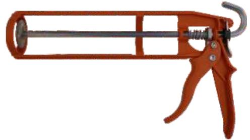
Kunststoff-Handfugenpistole für Einzelkartuschen. Dank automatischer Kolben-Entlastung kein Nachlaufen. Kraftübersetzung: 7:1. Gewicht: ca. 0.32 kg.
